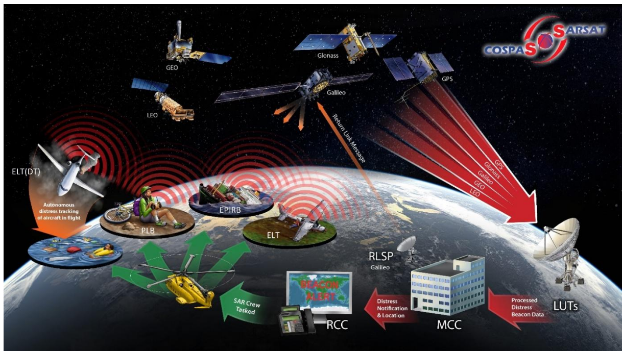
รูปภาพที่ 1 แนวคิดการทำงานของระบบดาวเทียม COSPAS – SARSAT วงโคจรพิสัยกลาง (The MEOSAR System Concept)
